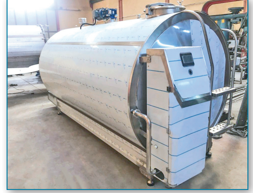
Süt Soğutma Tankı Milk Cooling Tank
